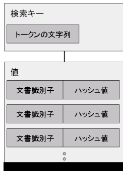
図 2 N.M-gram 法の転置インデックスの構造 Fig.2 Structure of Inverted Index of N.M-gram
